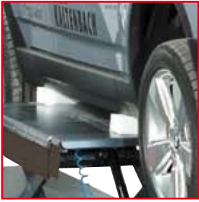
Elastomeraufnahmen für die Fahrzeugaufnahme
