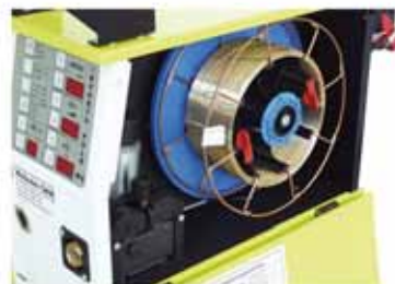
Drahtwechsel einfach und bequem, Aufnahme für kleine Korbspulen oder auch Korbspulen bis 17 kg.
