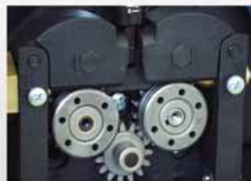
4-Rollen Antrieb in Top-Qualität für lange Standzeiten.
