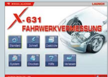
Aus dem Grundmenü lassen sich die drei Vermessungsarten per Funktionstaste starten
