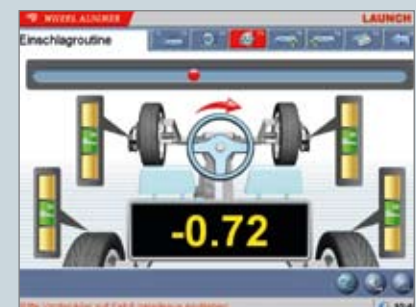
Hier wird die Einschlagroutine ausgeführt und gleichzeitig der Status der Messköpfe gezeigt
