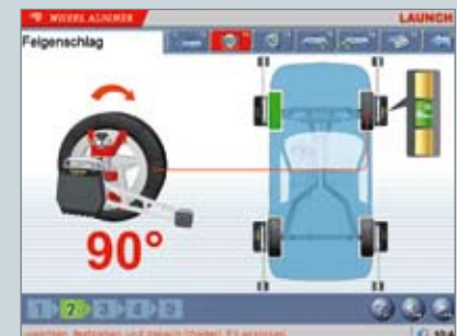
Die Anweisungen erfolgen wie hier bei der Felgenschlagkompensation in Klartext
