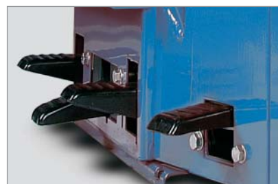
Il sistema di gonfiaggio controllato da pedale tramite griffe facilita notevolmente il lavoro.
