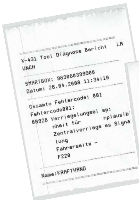
Schwarz auf weiß: Der integrierte Thermodrucker ermöglicht das sofortige Ausdrucken von Messwertblöcken, Fehler Speichereinträgen oder auch von Steuergerätedaten. Bild: Krafthand
