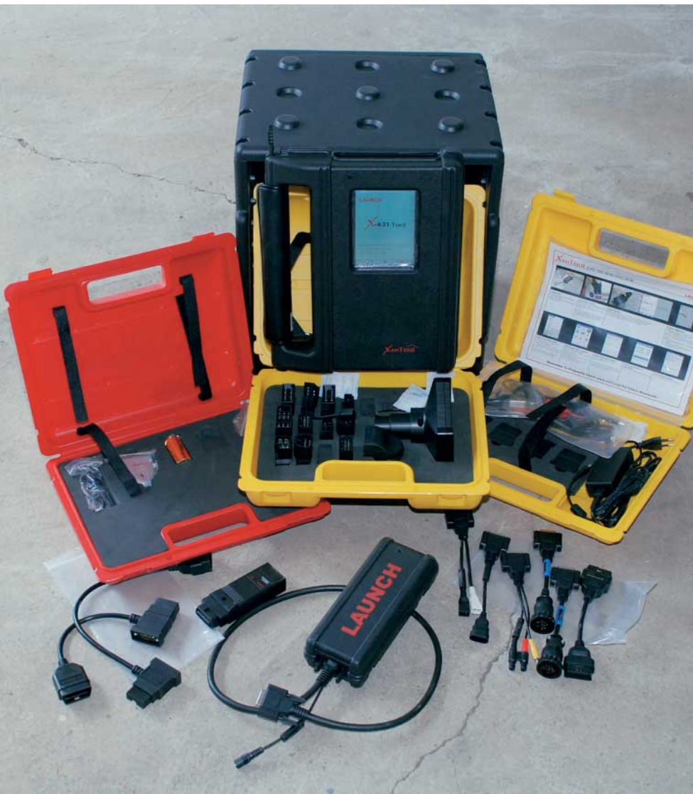
All inclusive: Im Lieferumfang des ‚X-431 Tool‘ von Launch befinden sich unter anderem eine Vielzahl von Adaptern für die unterschiedlichen Diagnosedosen sowie ein Ladekabel, zwei Kabel zur externen Spannungsversorgung, ein Kartenleser und die so genannte Smartbox. Bilder: Schmidt
