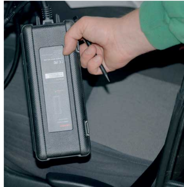
Bindeglied: Die so genannte Smartbox ist über ein Kabel mit dem jeweils benötigten Adapter an die Diagnoseschnittstelle angeschlossen und ermöglicht somit die Kommunikation zwischen Steuergerät und Tester.
