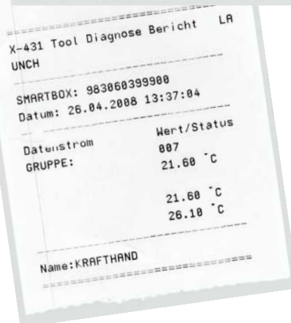
Schwarz auf weiß: Der integrierte Thermodrucker ermöglicht das sofortige Ausdrucken von Messwertblöcken, Fehler Speichereinträgen oder auch von Steuergerätedaten. Bild: Krafthand
