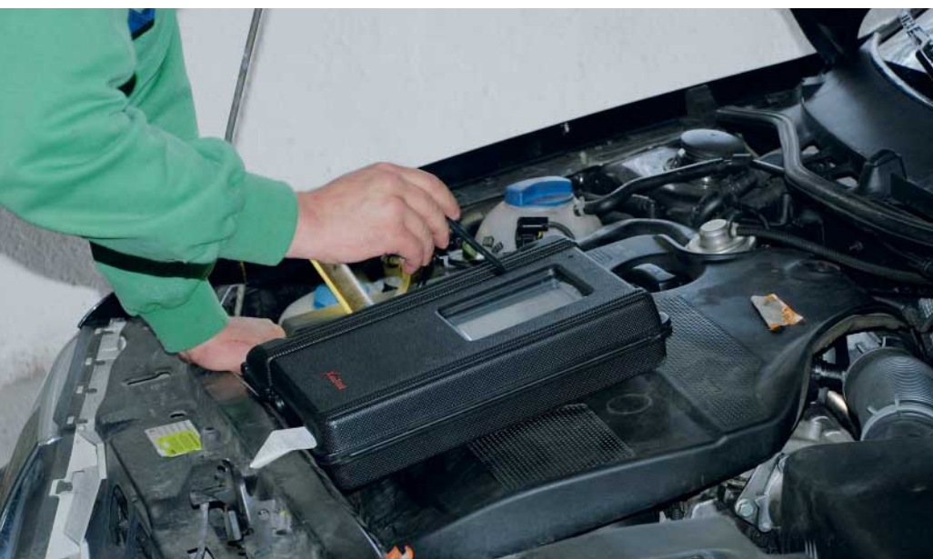
Schwarz auf weiß: Der integrierte Thermodrucker ermöglicht das sofortige Ausdrucken von Messwertblöcken, Fehler Speichereinträgen oder auch von Steuergerätedaten. Bild: Krafthand
