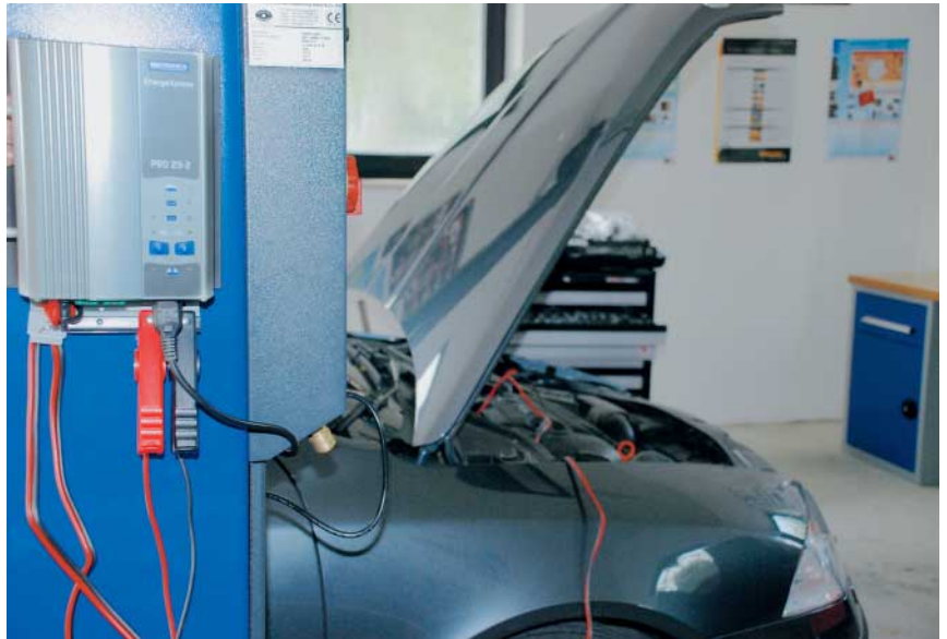
Unter Strom: Damit auch längere ‚Diagnose-Sessions‘ keine negativen Folgen für die Testfahrzeuge haben, kommt in der Werkstatt das Ladegerät ‚ChargeXpress pro 25-2‘ von Midtronics zum Einsatz.
