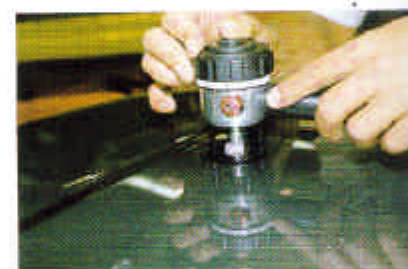
Mit dem neuen Gerät wird dann die Delle aus dem Blech gezogen.
