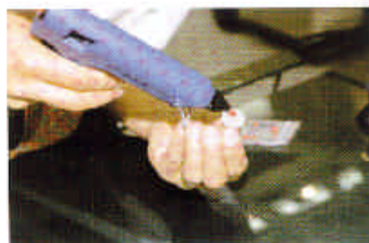
Zum lackschadensfreien Ausbeulen mit dem DingPuller wird im ersten Schritt Heißkleber auf den Klebe-Pad aufgetragen ...
