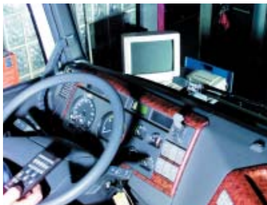
Vollautomatische Wegstrecken-Messung per Prüfstand-Fernbedienung vom Fahrersitz aus.
