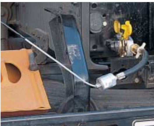
Die Kabelversion zur Ermittlung der Pm/Px-Einsteuerdrücke.
