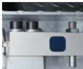
Achslastwaagen zur Erfassung des statischen oder dynamischen Prüfgewichtes.
