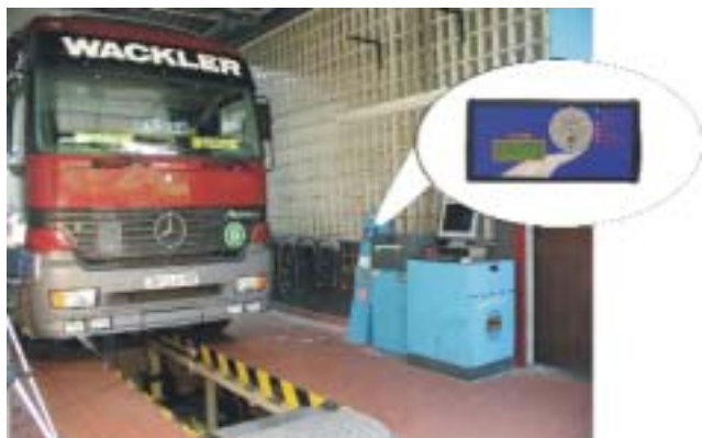
Wegstrecken-Fahrtenschreiber-Messgerät TC-Net für die Prüfung vom Fahrersitz aus per Induktivgeber.
