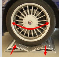
Gegenläufige Querbewegung zur Überprüfung der Lenkhebel und -Gelenke
