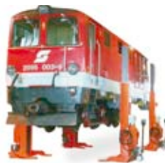
Mobile Hebeböcke EHB für Schienenfahrzeuge bis 100 t
