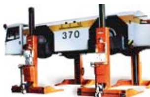
Mobile Radgreifer EHB für Flughafenfahrzeuge bis 60 t
