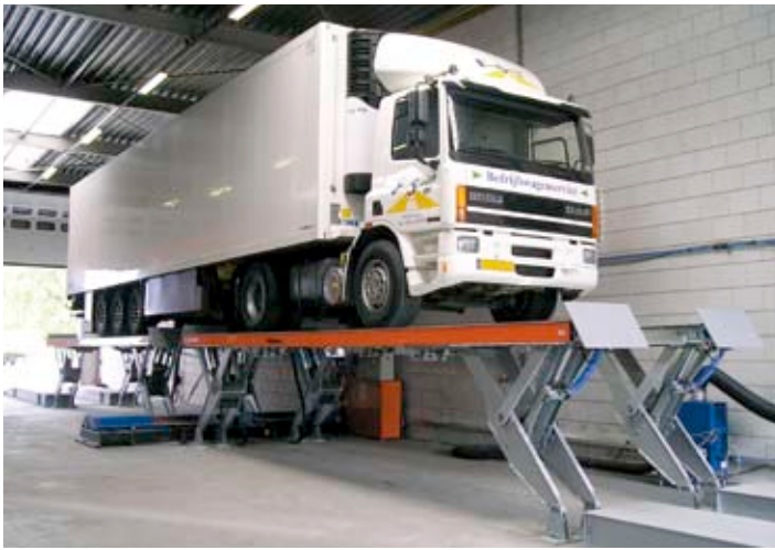
Tandembühne mit Bremsenprüfstand und Achsspieltester integriert in Prüfstrasse.
