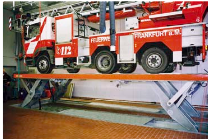
Die Unterflur-Ausführung ist auch mit automatischem Bodenausgleich ausrüstbar.
