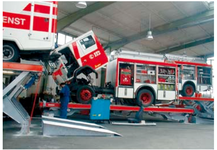
Die ideale Arbeitshöhe lässt sich stufenlos einstellen.
