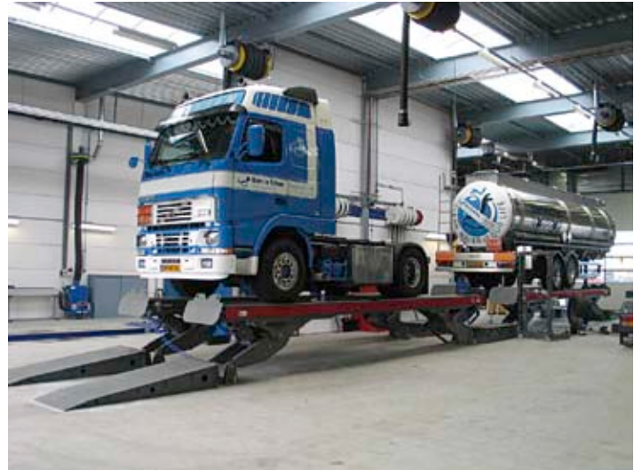
Aus der Tandembühne werden bei Bedarf zwei getrennt steuerbare Singlebühnen.
